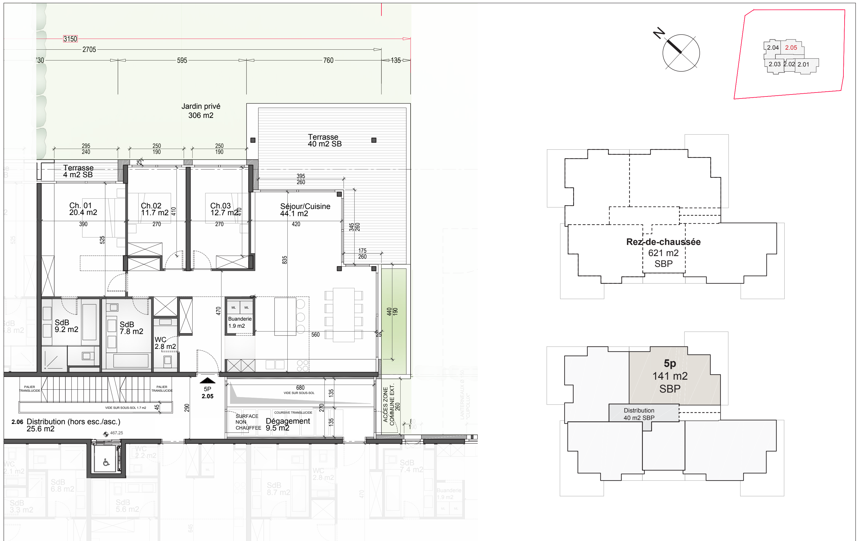
Plan typologie, Rez-de-chaussée , appartement 2.05 1:100
